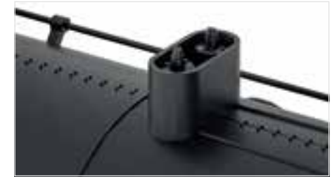
Sicherheitsventile nach PKP-Bauart
