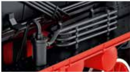
Aufwendig nachgebildeter Lufttrockner mit Ölabscheider
