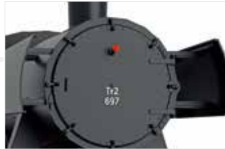
Rauchkammertüre in flacher Ausführung
