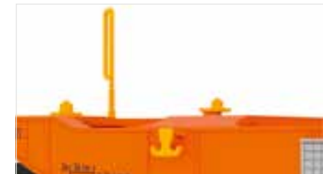
Separat angesetzte Seilankerhaken
