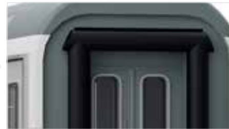
Betriebszustand mit Gummiwulst-Übergang
