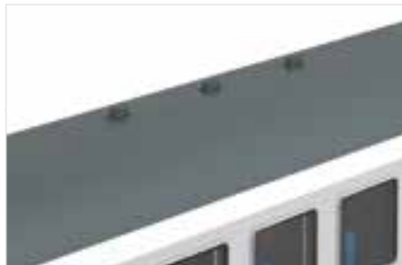
Separat angesetzte WLAN-Antennen
