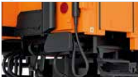
Pufferbohle vollständig zurüstbar
