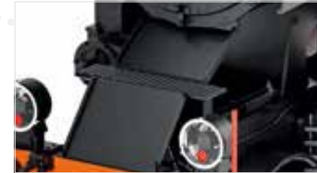
Schütte unter der Rauchkammertüre
