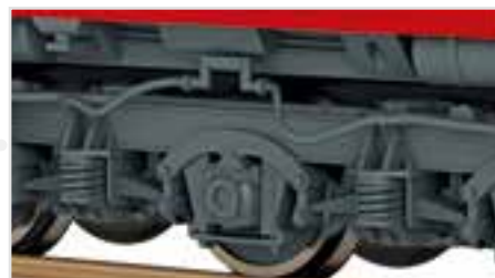
Vollständige Nachbildung der Bremsluftleitungen
