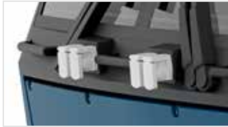
Filigrane extra angesetzte Griffstangen, UIC-Dosen und Scheibenwischer
